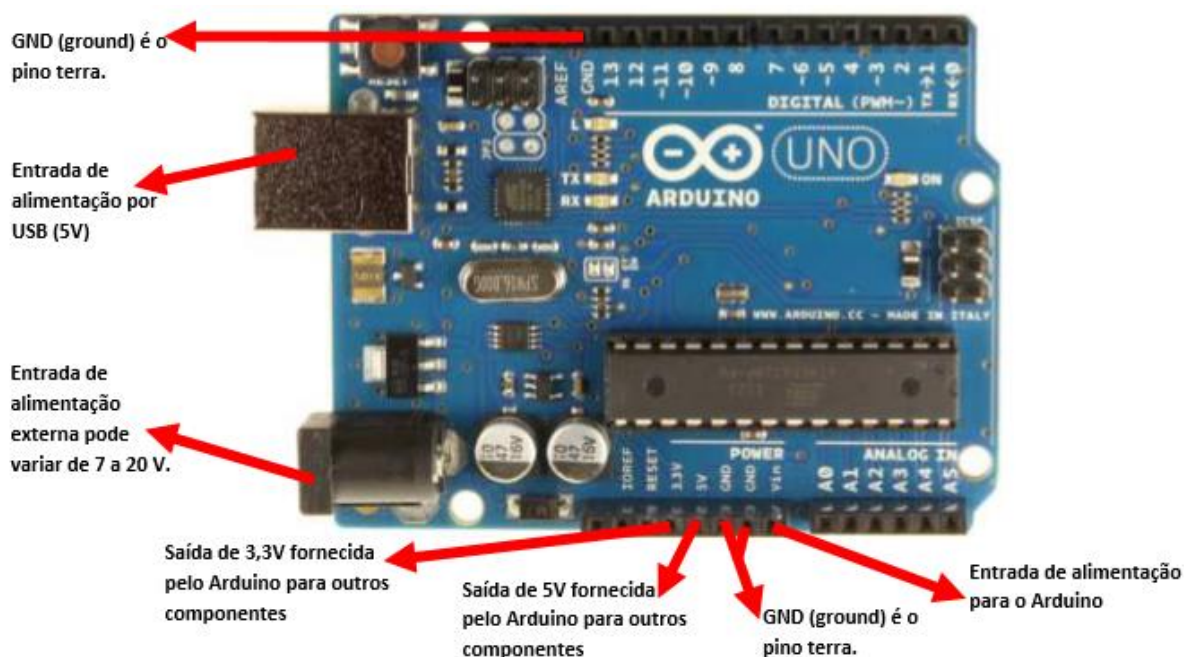
Figura 04 - Placa Arduino e suas ligações de alimentação. Fonte: Extraído de Fabri Junior (2014, pág. 9).
