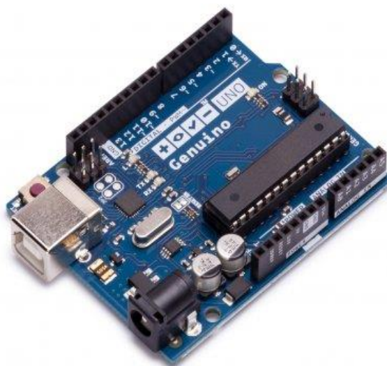
Figura 02 – Placa Genuino Uno Utilizada na Pesquisa. Fonte em < http://arduino.cc >
