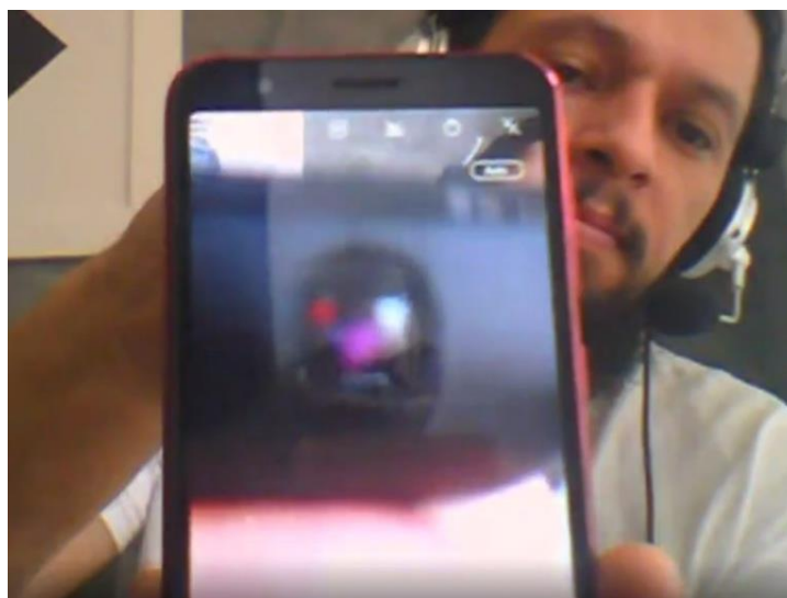
Figura 19 – Controle remoto funcionando diante da câmera do celular (Fonte: arquivo pessoal)
