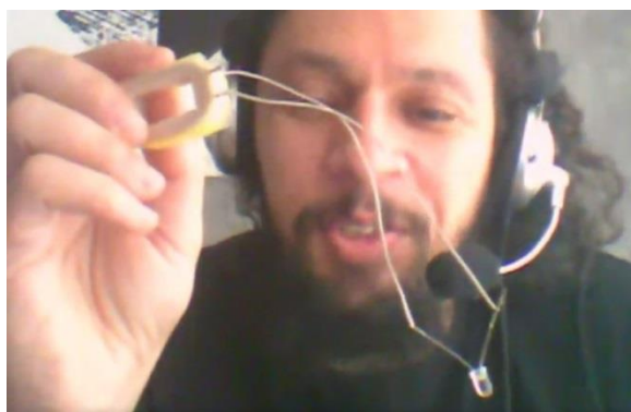
Figura 26 – LED conectado a bobina (Fonte: acervo pessoal)
