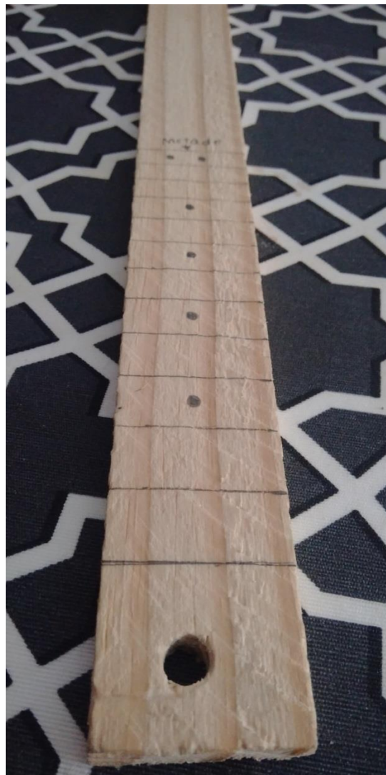
Figura 4 - Distância dos trastes calculados
