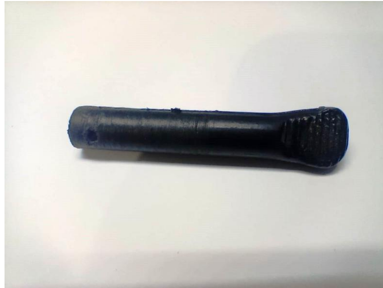
Figura 2 - Tarraxa feita de plástico de cabide de guarda-roupa
