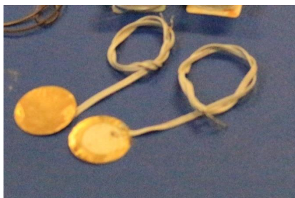
Figura 14 - Piezoelétrico com os fios soldados
