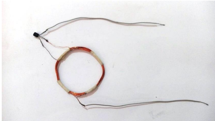
Figura 23 - Bobina primária conectada ao transistor e os fios.
