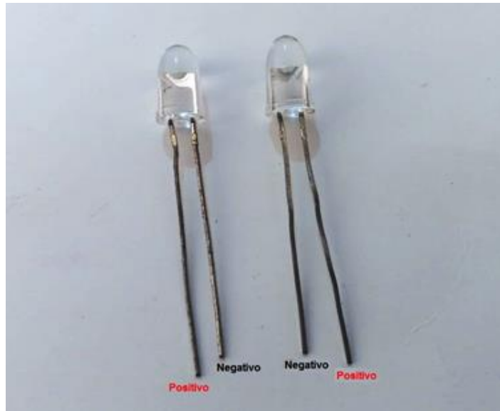
Figura 10 - LED e sua polaridade
