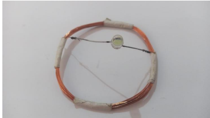
Figura 21 - Bobina secundária (5 cm de diâmetro), com fita adesiva, conectada ao LED
