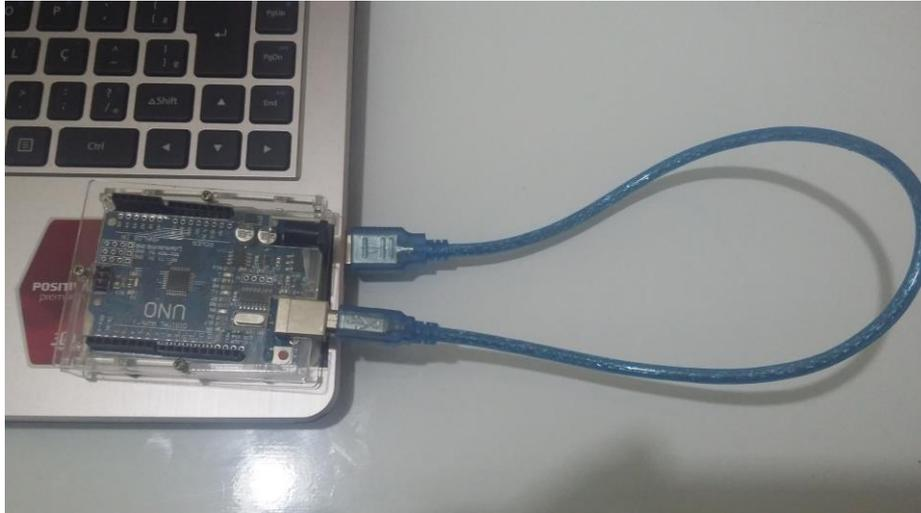
Figura A.3 – Conexão do Arduino com o computador através do cabo USB.
